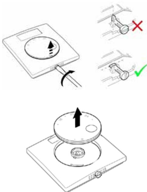
1. Utilizzando un cacciavite ruotare di circa 90° la vite a camme posta sulla parte inferiore del prodotto.
