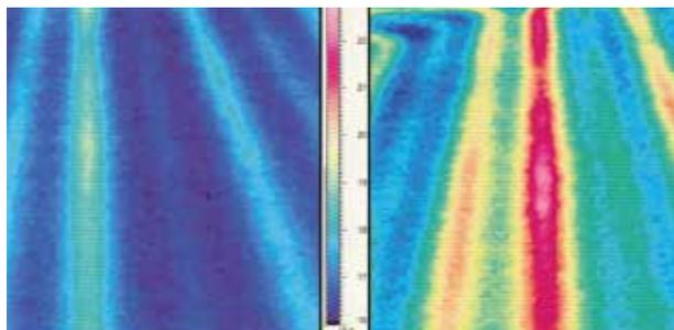
Grazie al basso spessore costruttivo, il pavimento reagisce molto più velocemente nei cambi di temperatura.
